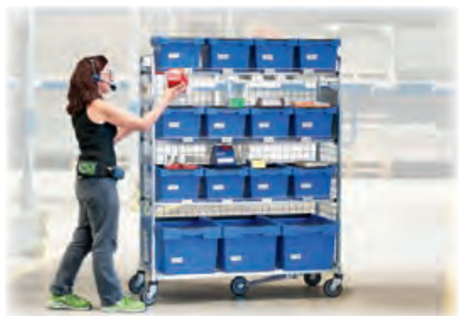
„Pick by Voice“: Eine Kommissioniererin mit „Kommunikationsgürtel“ und Headset, ihr Wagen und die Boxen.
